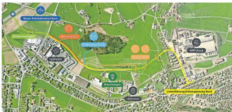
Die Linienführung der Netzergänzung Nord. Die Strasse soll vom geplanten Autobahnzubringer Wil West an die AMP-Strasse führen. Zwischen dem Friedhof und der Auffahrt beim AMP-Areal ist ein gut 300 Meter langer Tunnel geplant (In der Visualisierung gestrichelt dargestellt). Der Abschnitt bei der Autobahn ist mit Lärmschutzwänden versehen. Wie Thomas Vögeli beanstandet, werden die Industrie und der Friedhof somit geschützt, die Anwohner aber kaum. z.v.g
