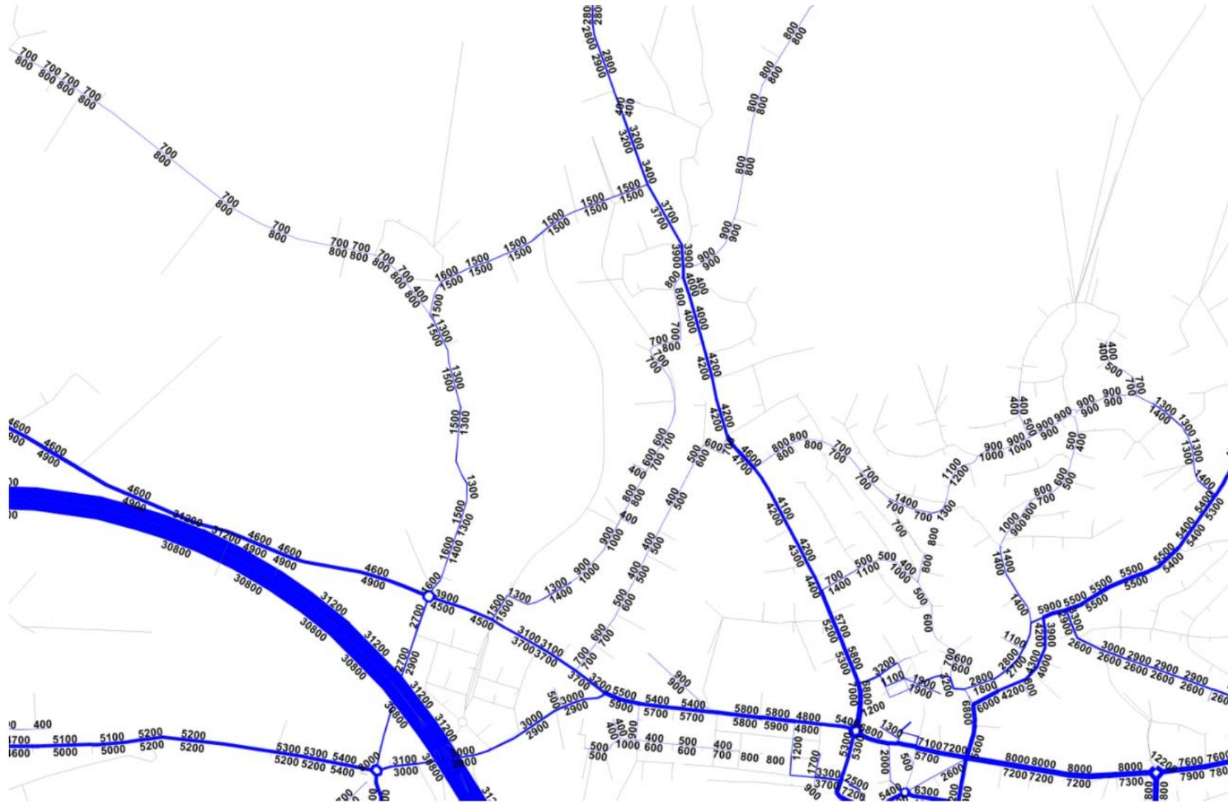
Abbildung 25 Grundbelastung DWV des Netzes im Istzustand (Fz./Tag) [4]
