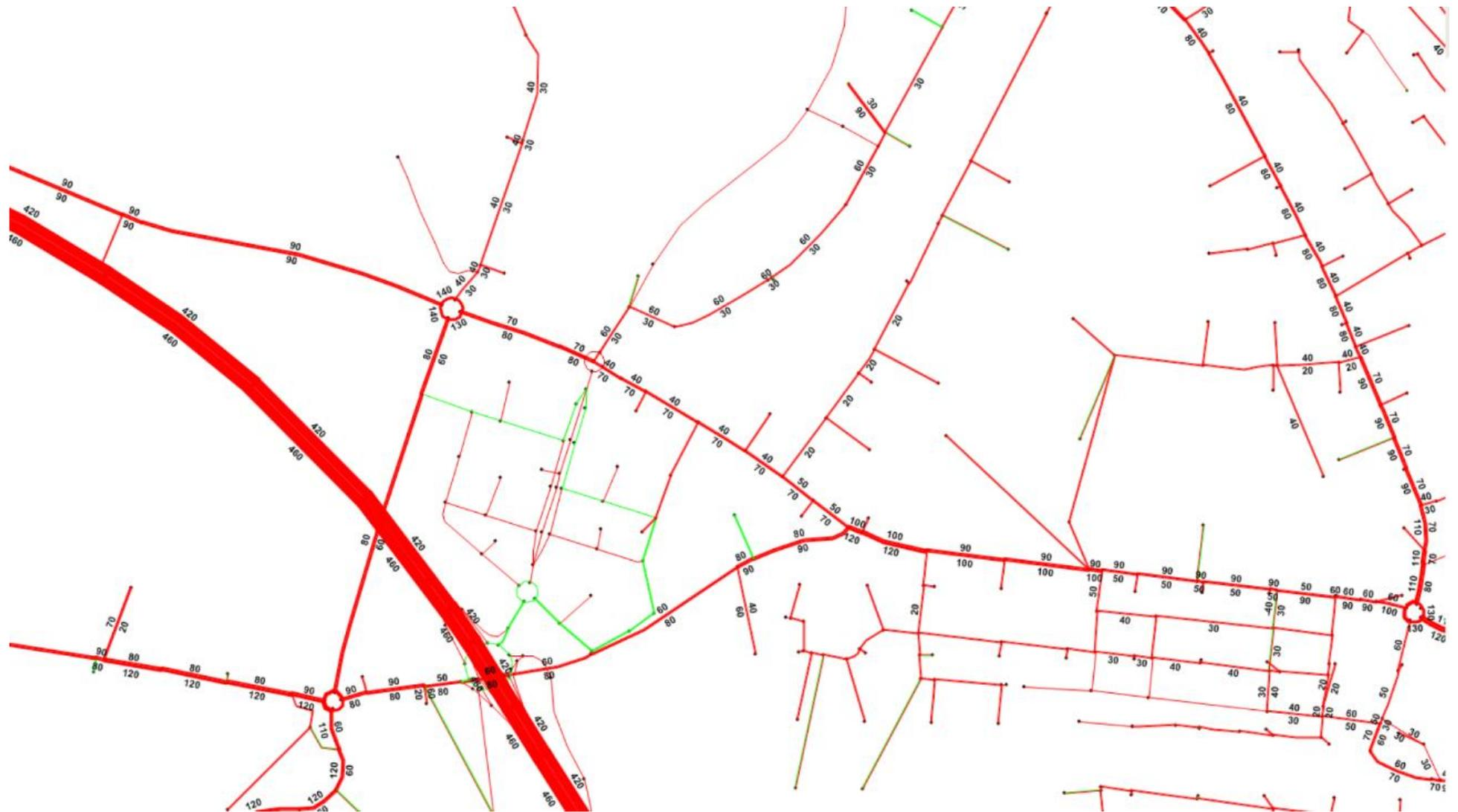
Abbildung 18 Differenzenplot des Netzes im Referenz- zum Istzustand während der ASP (Fz./h) [4]
