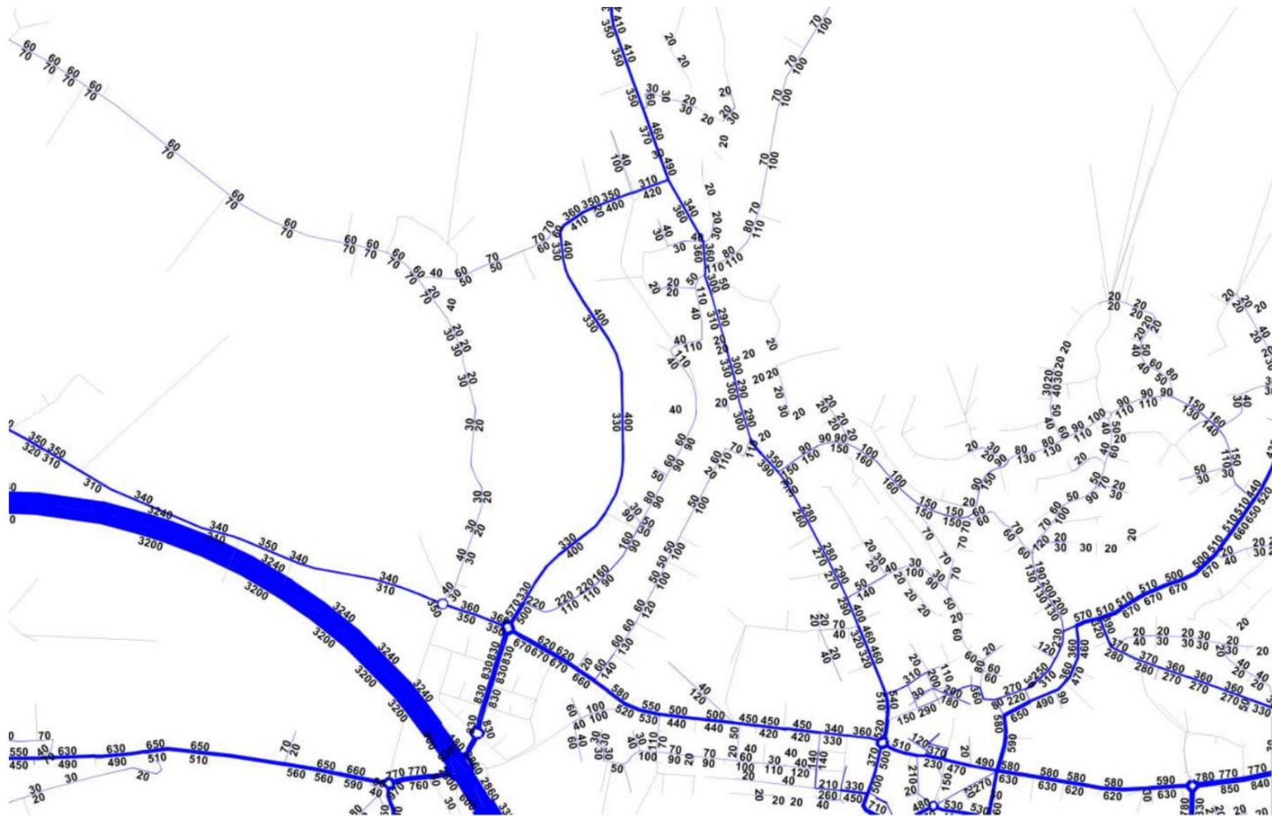
Abbildung 17 Grundbelastung des Netzes im Projektzustand während der ASP (Fz./h) [4]
