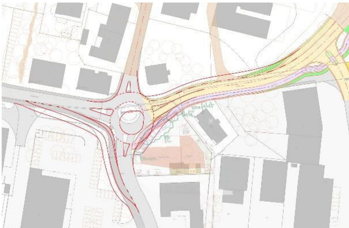
Variante 4, Bypass mit einem Turbokreisel am Knoten Gloten (aus [3])
