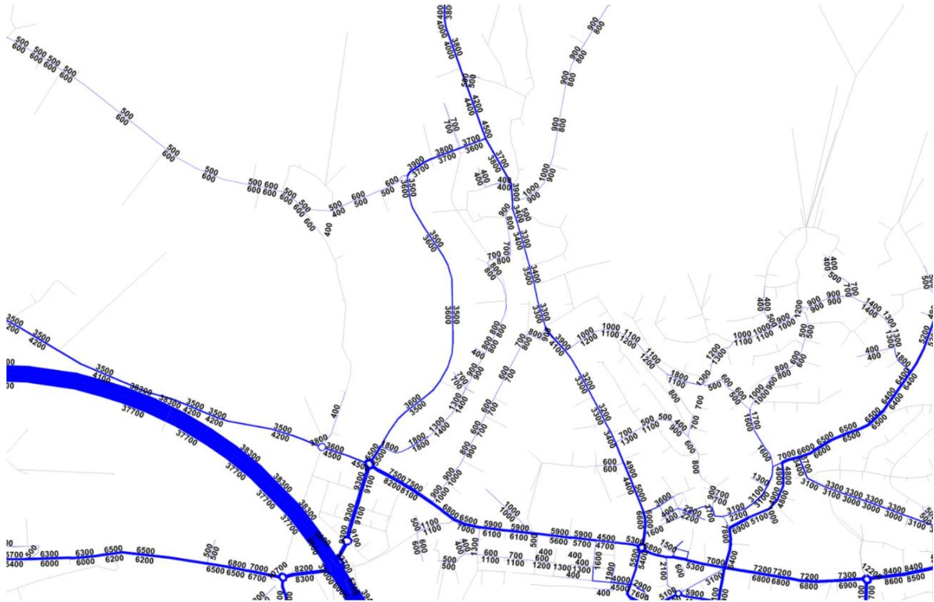
Abbildung 27 Grundbelastung DWV des Netzes im Projektzustand (Fz./Tag) [4]
