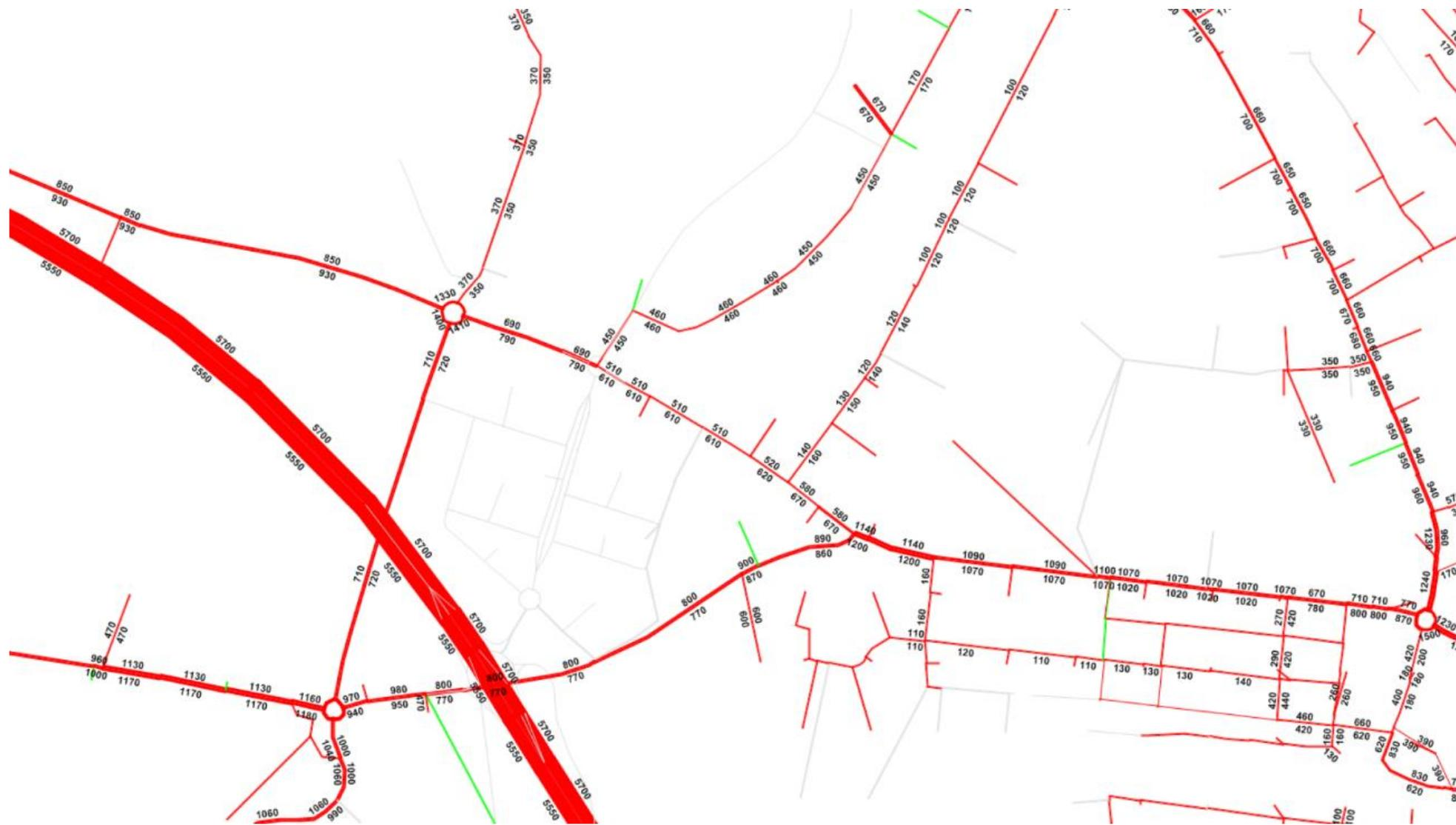
Abbildung 28 Differenzenplot DWV des Netzes im Referenz- zum Istzustand (Fz./Tag) [4]
