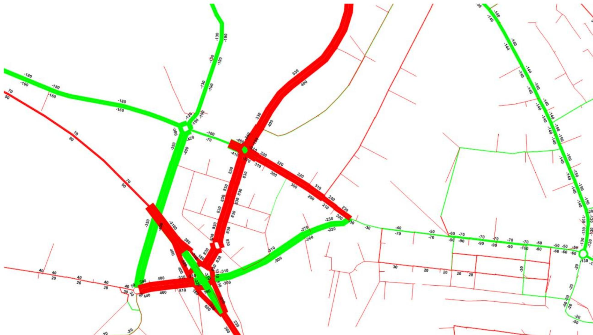
Abbildung 19 Differenzplot des Netzes im Projekt- zum Referenzzustand während der ASP (Fz./h) [4]
