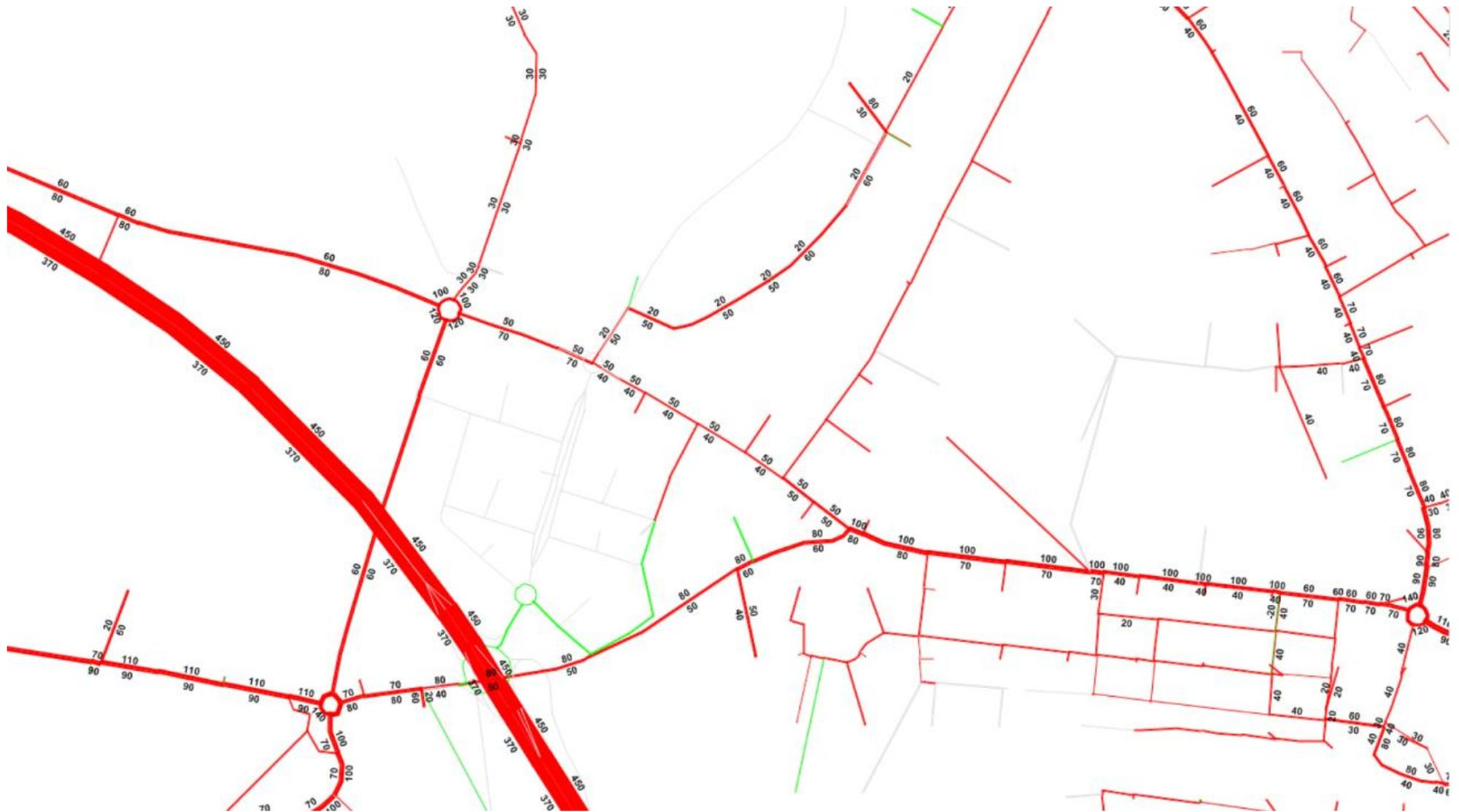
Abbildung 23 Differenzenplot des Netzes im Referenz- zum Istzustand während der MSP (Fz./h) [4]
