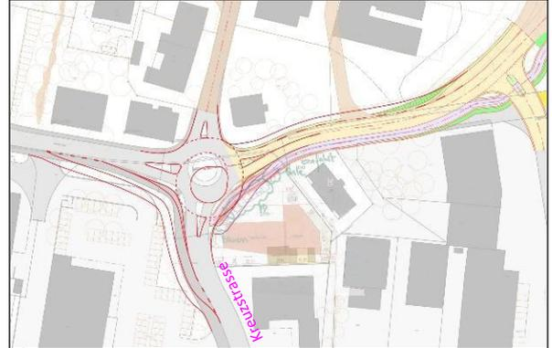
Abbildung 10: Variante 4, Bypass mit einem Turbokreisel am Knoten Gloten (aus [3])
