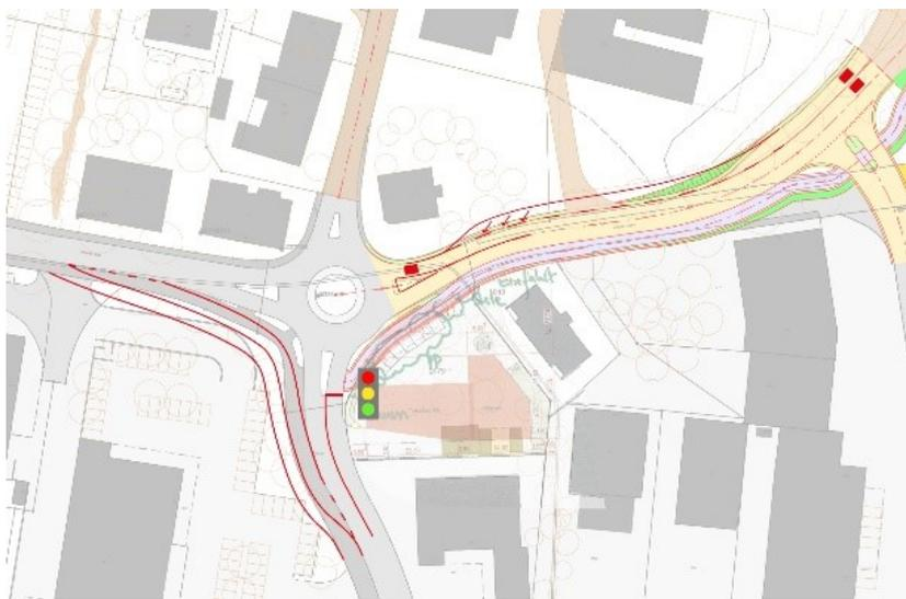
Abbildung 31 Bestvariante Knoten Gloten (Bypass mit einer Bedarfs-LSA und einer Doppelspur)
