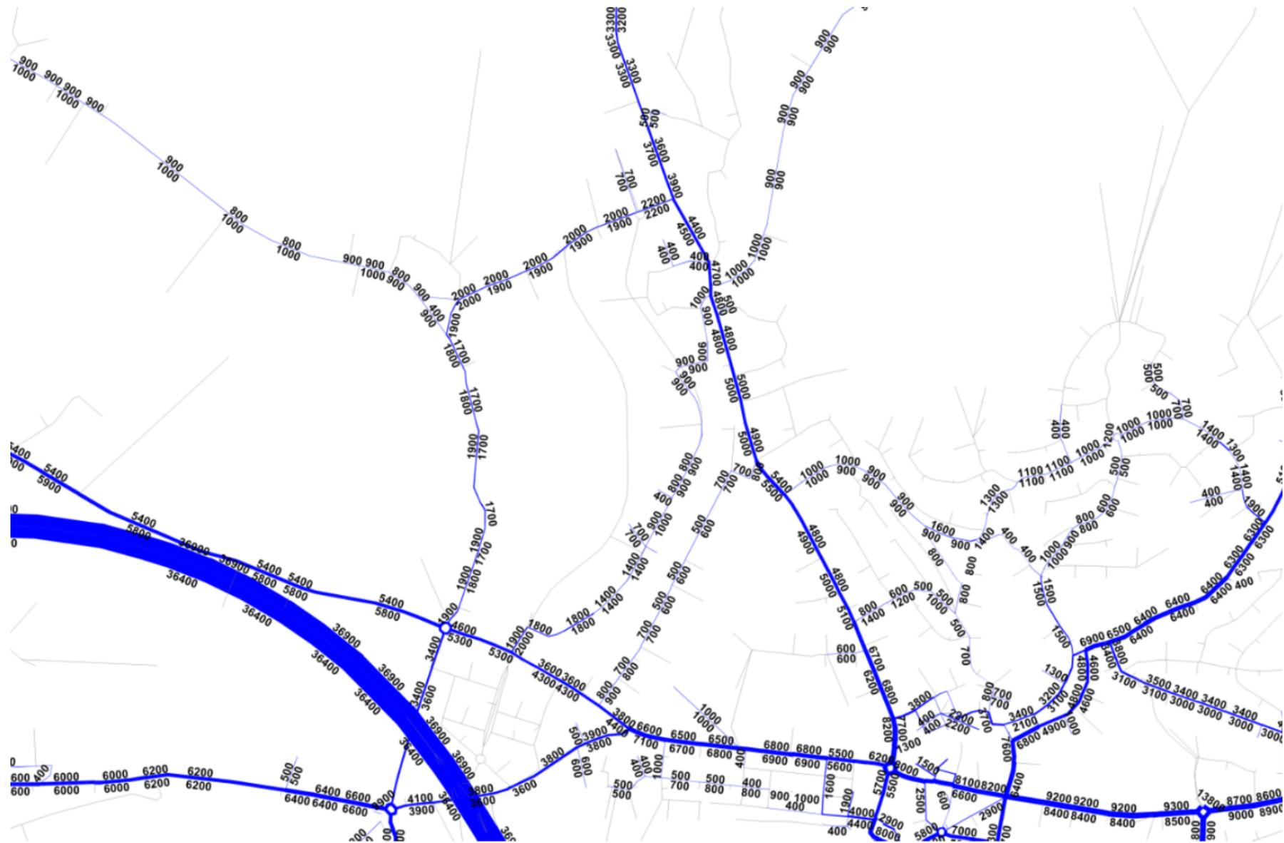
Abbildung 26 Grundbelastung DWV des Netzes im Referenzzustand (Fz./Tag) [4]
