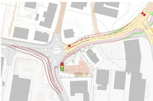
Abbildung 15 Variante 3: Bypass mit einer Bedarfs-LSA und einer Doppelspur
