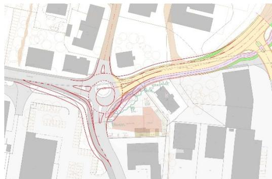
Abbildung 16 Variante 4: Bypass mit einem Turbokreisel am Knoten Gloten
