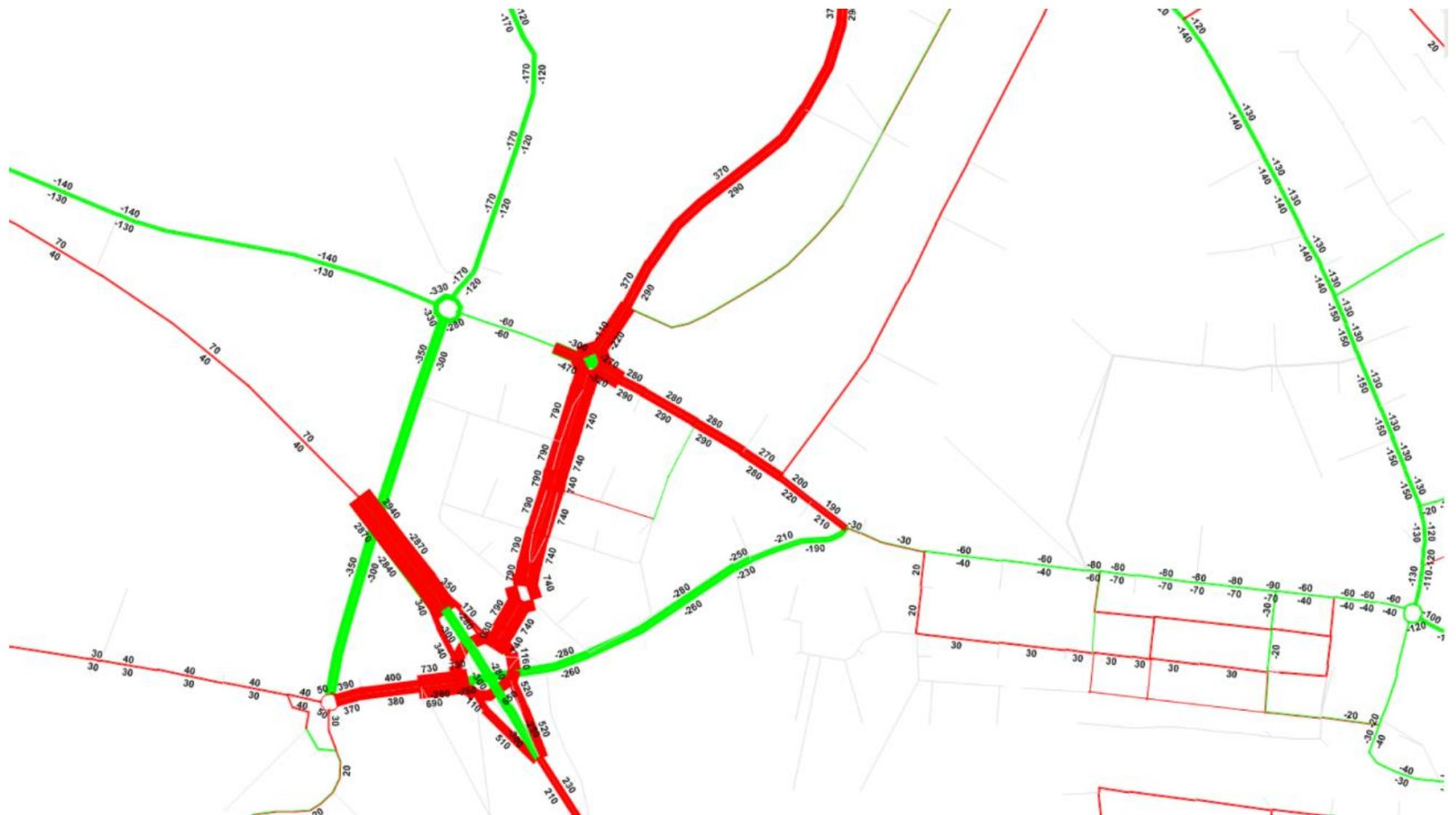
Abbildung 24 Differenzplot des Netzes im Projekt- zum Referenzzustand während der MSP (Fz./h) [4]
