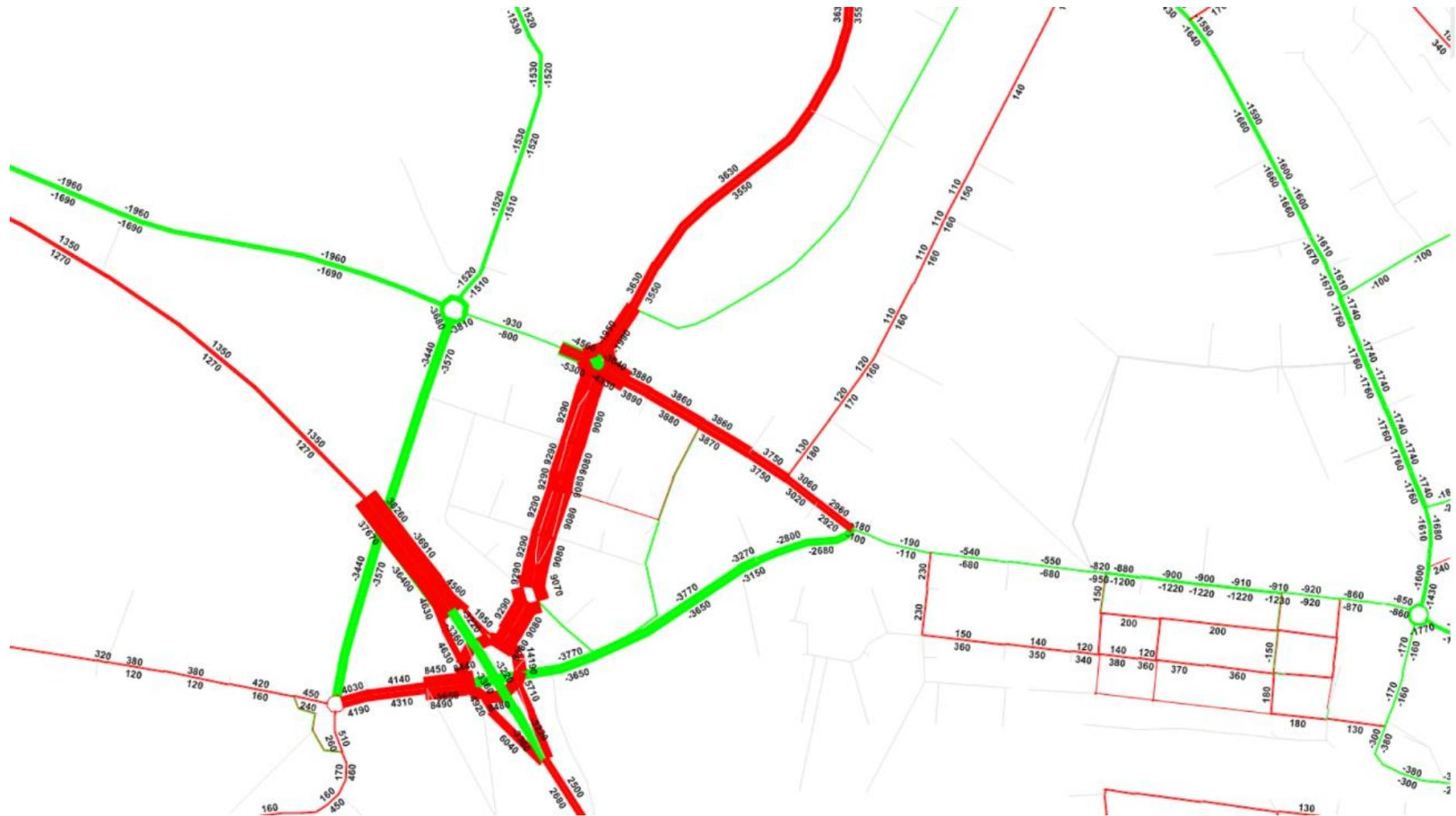
Abbildung 29 Differenzenplot DWV des Netzes im Projekt- zum Referenzzustand (Fz./Tag) [4]
