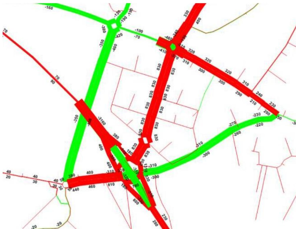
Abbildung 3: Differenzplot des Netzausschnittes im Projekt- zum Referenzzustand während der ASP (Fz/h), aus [1]
